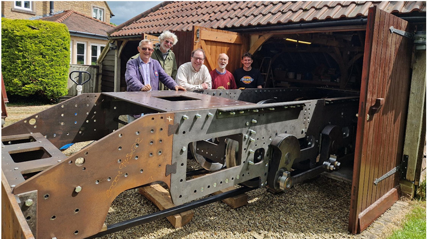
Y fframiau y tu allan i sied Jon, gyda'r prif dim (Stuart, Roger, Jon, Alan a Josh) y tu ôl i'r fframiau. Gwnaethpwyd y fframiau mewn tri darn, yn bennaf oherwydd cyfyngiadau y sied, ond hefydd oherwydd cyfyngiadau y peiriannau torri.
