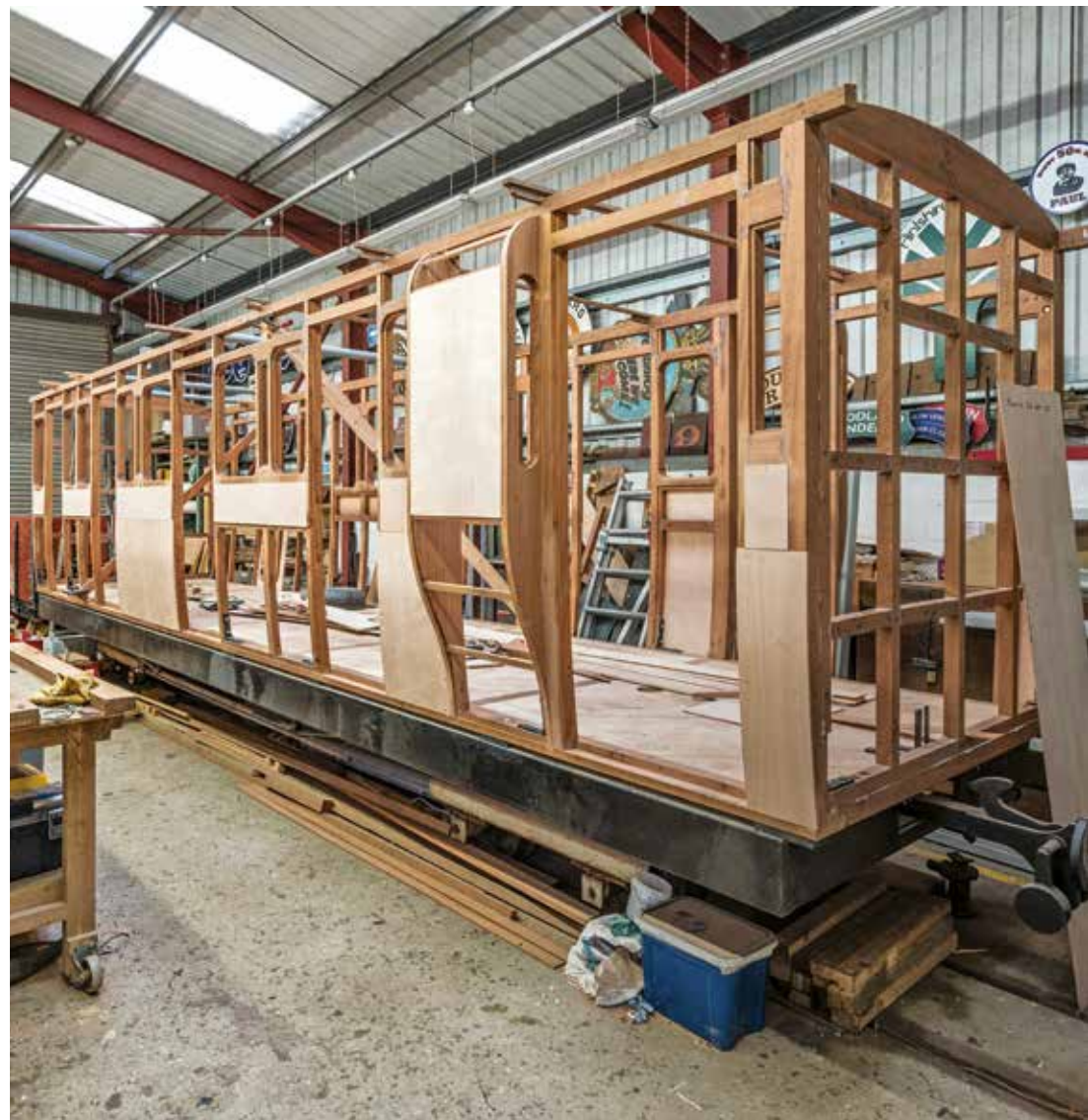
Mae replica o gerbyd brêc-cyfansawdd Ashbury o'r 1870au yn cael ei adeiladu ar gyfer fflyd treftadaeth Rheilffordd Eryri gan Waith Cerbydau Boston Lodge (John Dobson)
